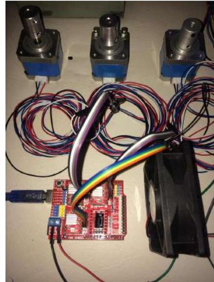
Fig. 22. Ligação do motor de passo através da *CNC shield*.
