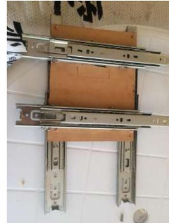
Fig. 18. Trilho de gaveta telescópico *ligh* para gavetas como eixo X e Y.
