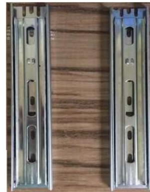
Fig. 19. Trilho de gaveta telescópico *ligh* para gavetas como eixo Z.
