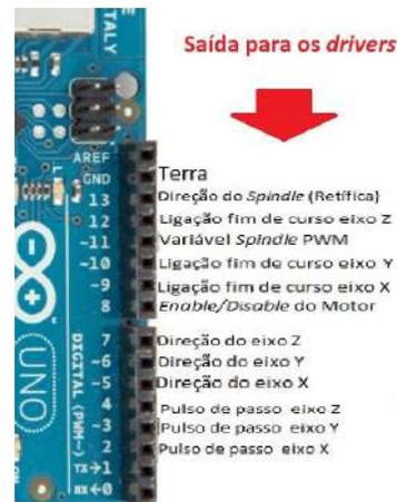
Fig. 27. Ligação de cada componente no Arduino.
