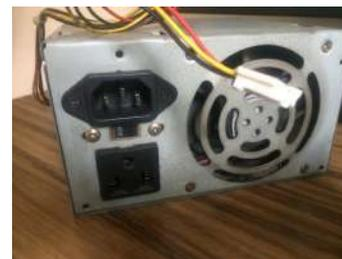
Fig. 28. Fonte de alimentação utilizada no protótipo .
