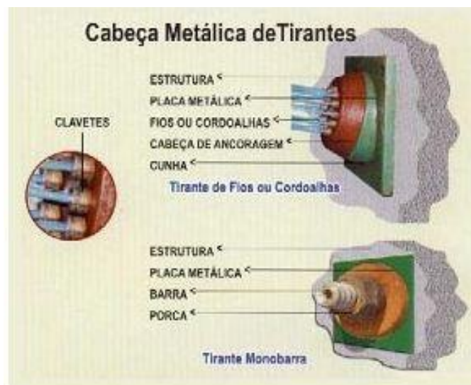
Figura 9 - Cabeça Metálica de tirantes de fio/monobarra
