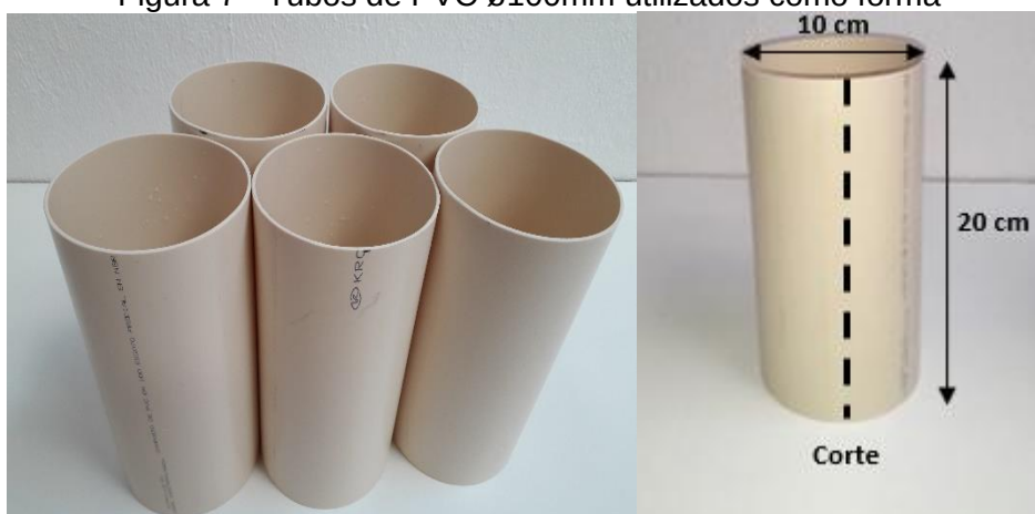
Figura 7 - Tubos de PVC Ø100mm utilizados como forma
