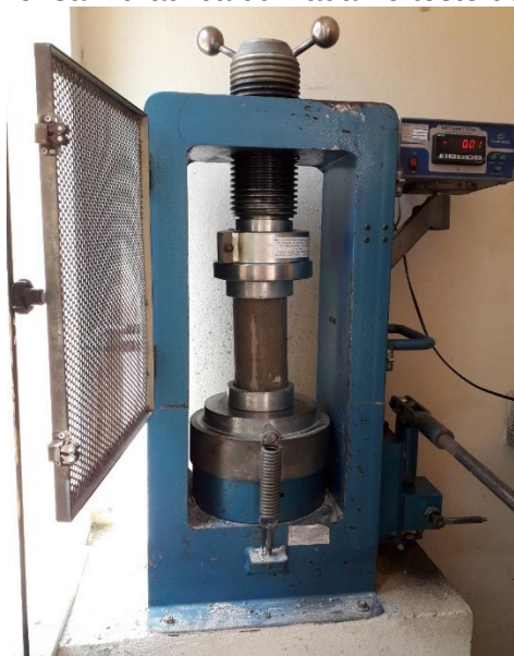
Figura 11 - Prensa hidráulica utilizada no teste de compressão
