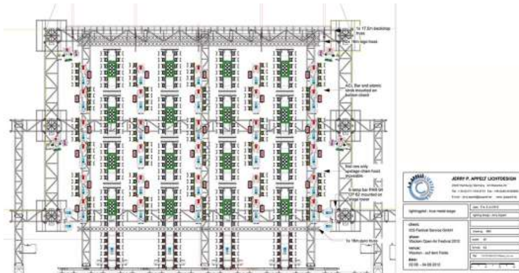
Figura 36- Projeto de iluminação
