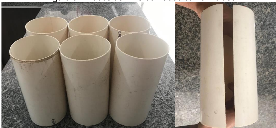
Figura 9 – Tubos de PVC utilizados como moldes
