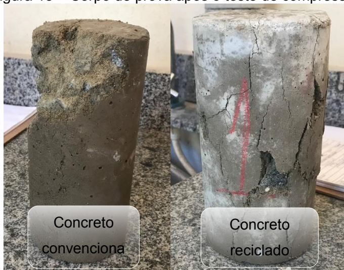
Figura 15 – Corpo de prova após o teste de compressão
