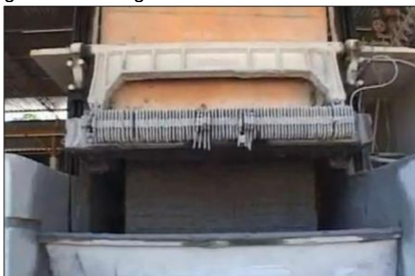
Figura 7 – Serragem do Bloco no Tear de Lâminas
