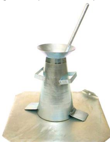
Figura 3 – Aparelho de Slump Test
