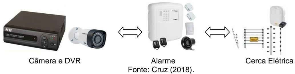
Nível 5: Sistemas integrados – com automação independente. Atuam de forma totalmente integrada, ou seja, comandados por uma central, de maneira autônoma e com funcionamento automático. Exemplos: sistemas de iluminação, segurança e controle de acesso trabalhando em conjunto (FIG. 20).
