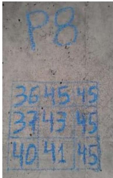
Figura 7 – Fotografia dos resultados de esclerometria no Pilar P8
