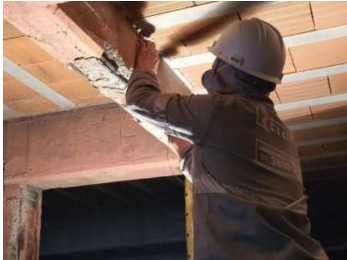
Figura 8 – Fotografia da extração do corpo de prova de aço
