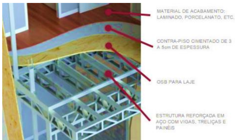
Figura 12- Estrutura do piso em LSF
