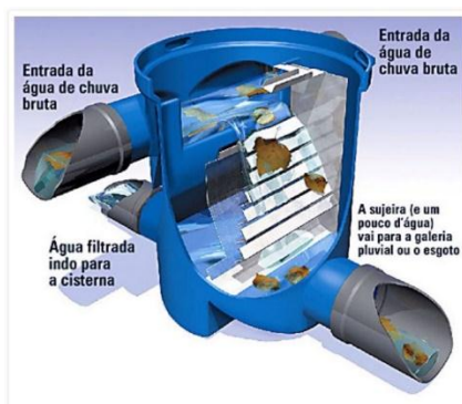
Figura 5 - Dispositivo de descarte de sólidos grosseiros.
