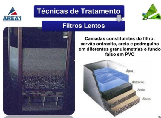
Figura 19 - Filtro lento de carvão antracito, areia e pedregulho.
