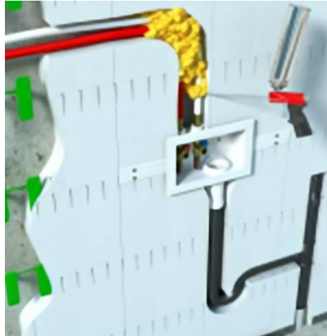
Figura 18 – Demonstrativo de furação e fechamento de formas
