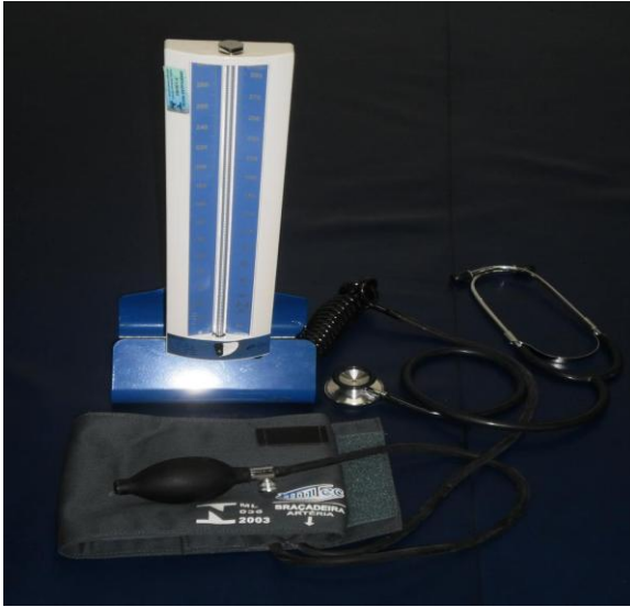
Figura 02. Material para avaliação da medida quantitativa, esfigmomanômetro de mesa de mercúrio e estetoscópio.
