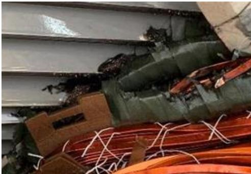
Fig. 10. Derretimento do núcleo em contato com as espiras
