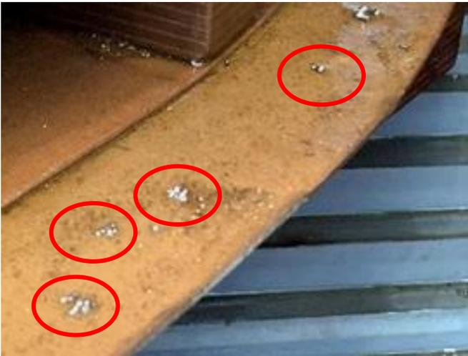
Fig. 11. Cobre pulverizado devido à elevada corrente de curto-circuito
