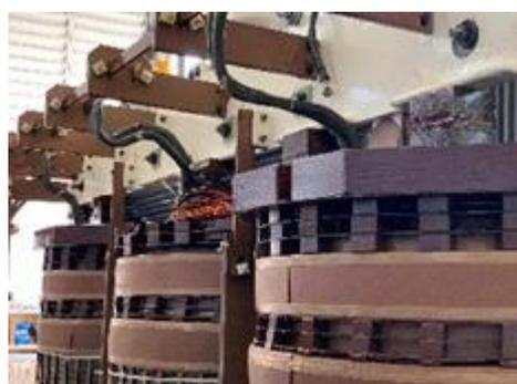
Fig. 8. Bobina da fase B danificada na extremidade
