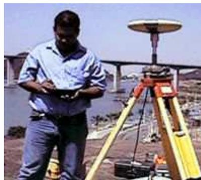
Antena GPS receptora (GPS SR-520 Leica)
