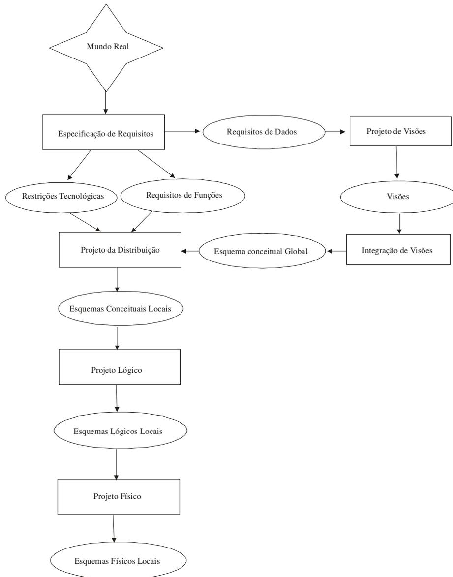
**Figura 4 - Visão geral do processo de projeto de BDD's homogêneos [9].**
