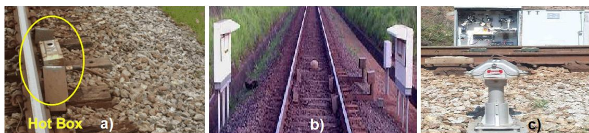
Figura 2 – a) Equipamento Hot Box; b) Equipamento RailBAM; c) Equipamento Hot Wheel.
