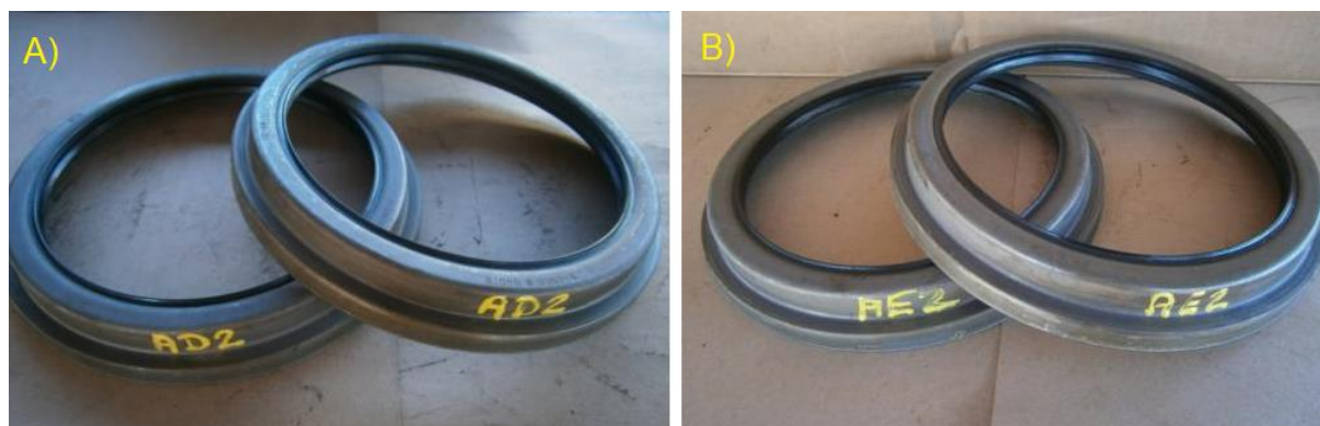
Figura 7 - Retentores após a inspeção: a) Rolamento 510993; b) Rolamento 508289. Fonte: Dados da pesquisa (2021).
