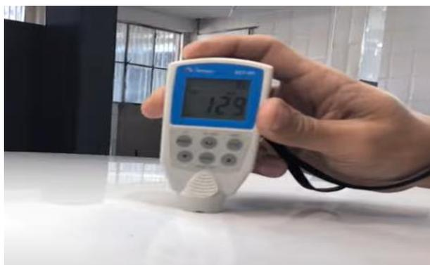
Figura 8 - Processo de medição do verniz automotivo
