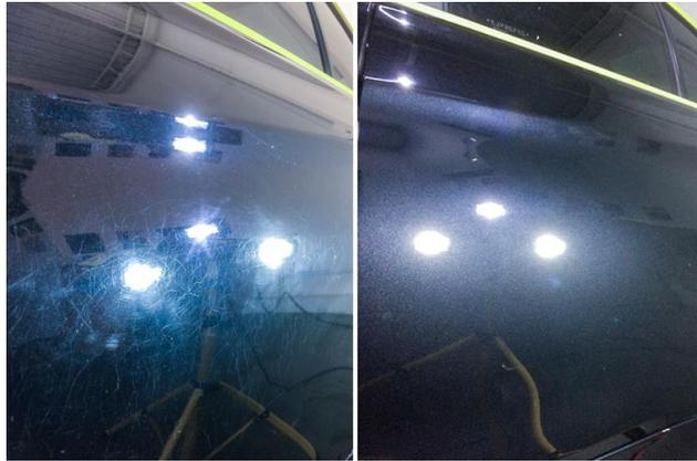
Figura 3 – Pintura sem lustro e Pintura com lustro
