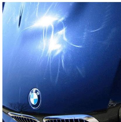
Figura 2 - Hologramas na pintura do carro
