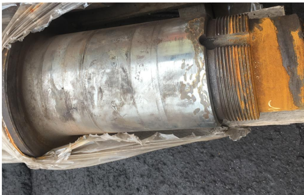
Figura 8 – Eixo com desgaste na sede dos rolamentos
