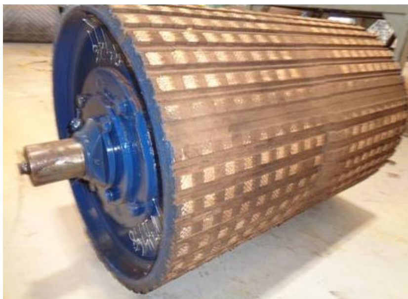
Figura 10- Tambor com revestimento de pastilha de cerâmica
