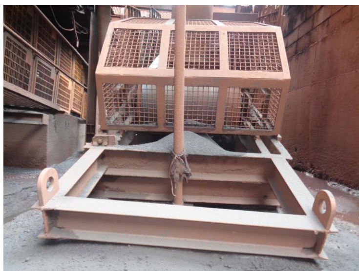
Figura 20 – Acúmulo de material no retorno da correia
