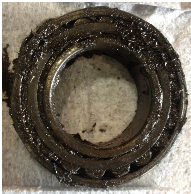
Figura 21 – Contaminação do rolamento
