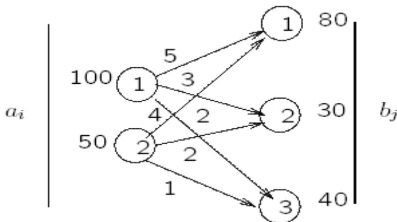
FIGURA 2 - Sistema de transporte com duas fontes e três destinos
