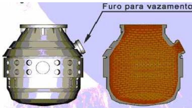
**Figura 3-7 Visão do Convertedor Internamente e Externamente[CD HIPERMÍDA]**
