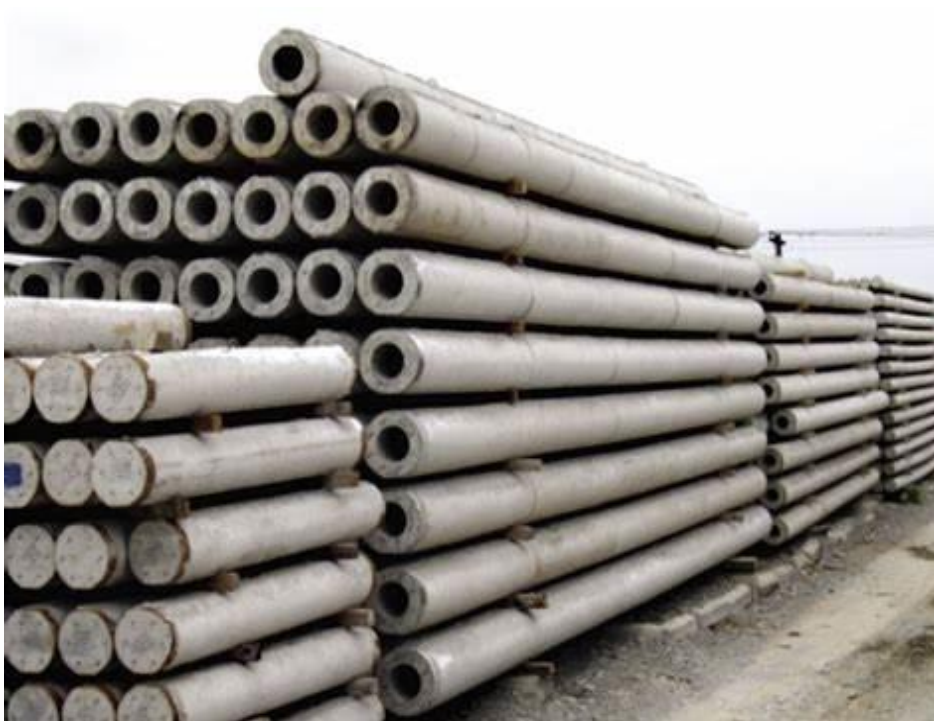
FIGURA 3 – Estacas pré-moldadas de concreto
