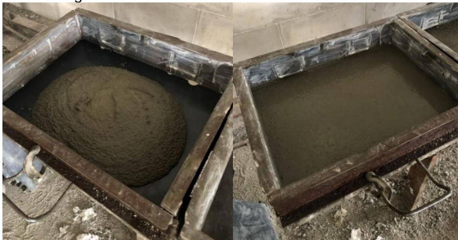
Figura 14: Formas com a massa de acabamento.
