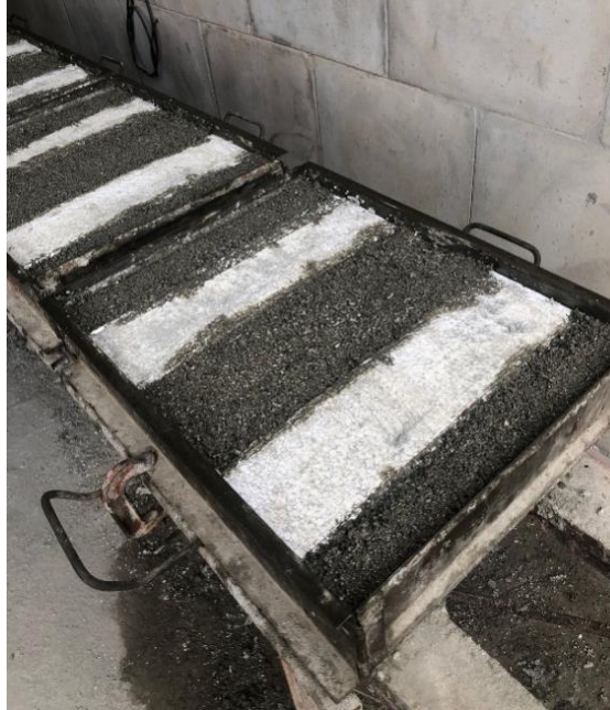
Figura 15: Formas com a massa de enchimento e as tabelas de EPS.
