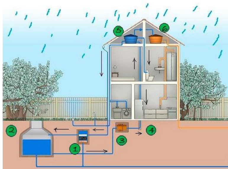
Figura 2: Sistema de captação de água pluvial
