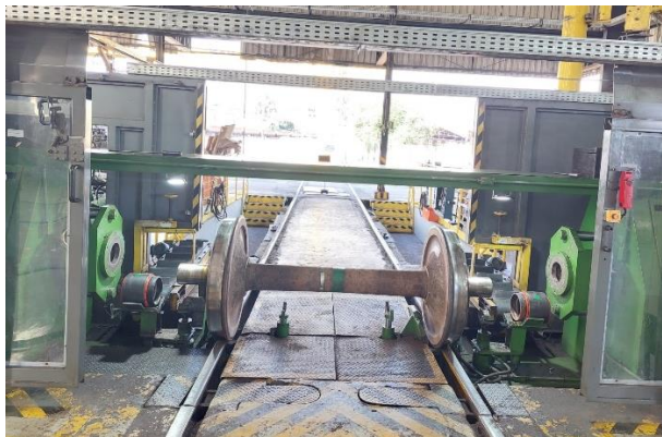
Figura 7 – Rodeiro na Prensa de Rolamento
