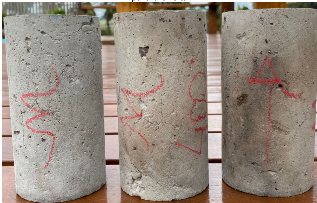
Figura 06 – Corpos de prova temperaturas ambiente, 400°C e 800°C da esquerda para a direita.
