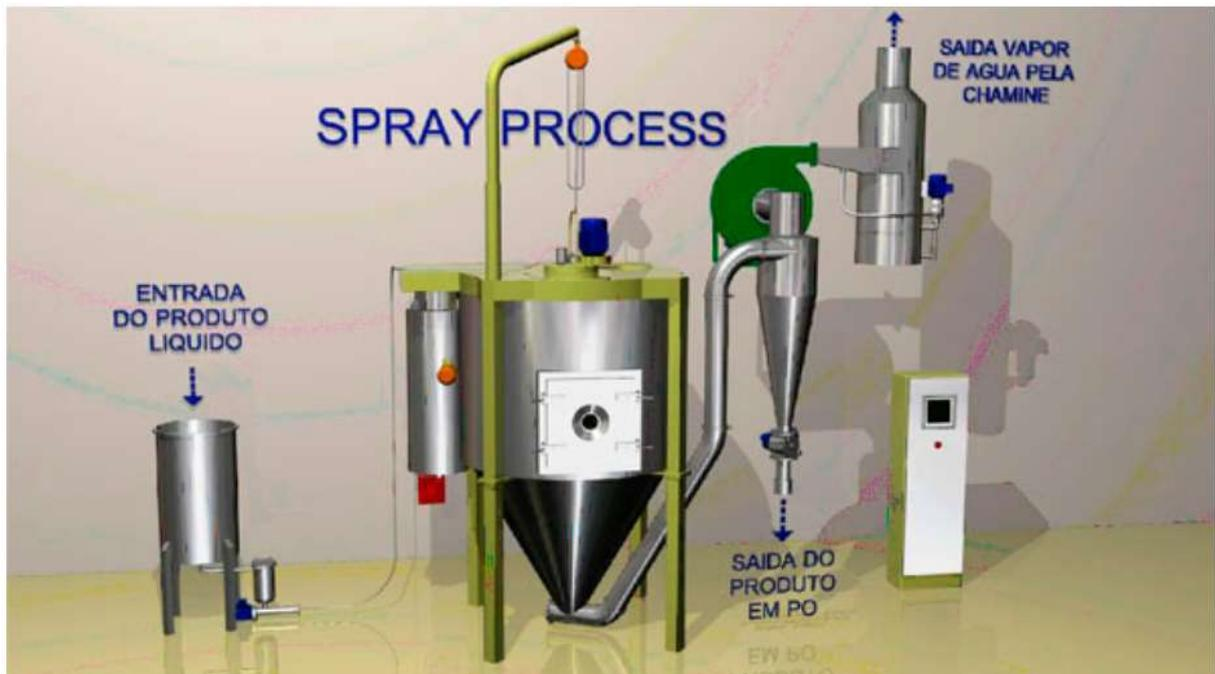
**Figura 3.** Processo de secagem por atomização.
