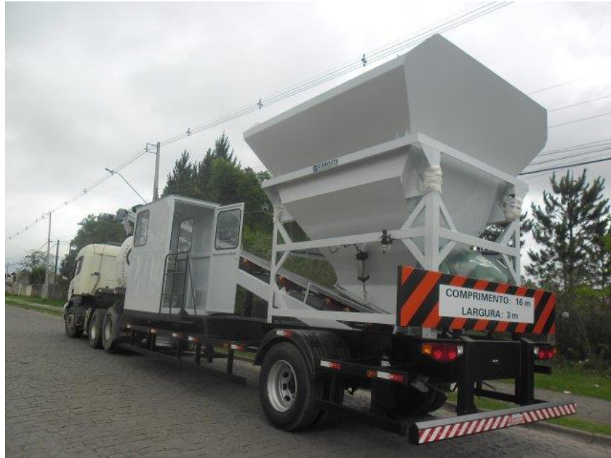
Figura 14 – Usina de concreto móvel
