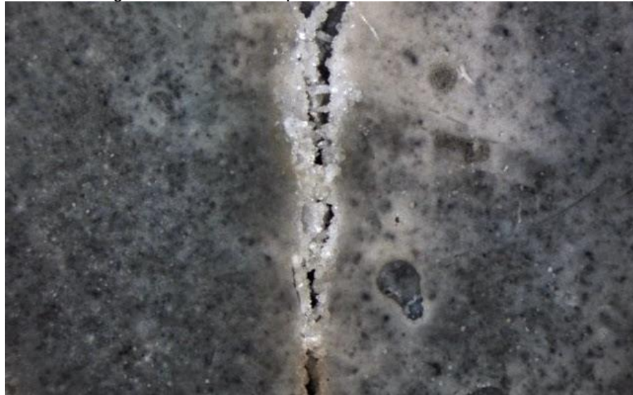
Figura 6- Concreto em processo de “auto cura”
