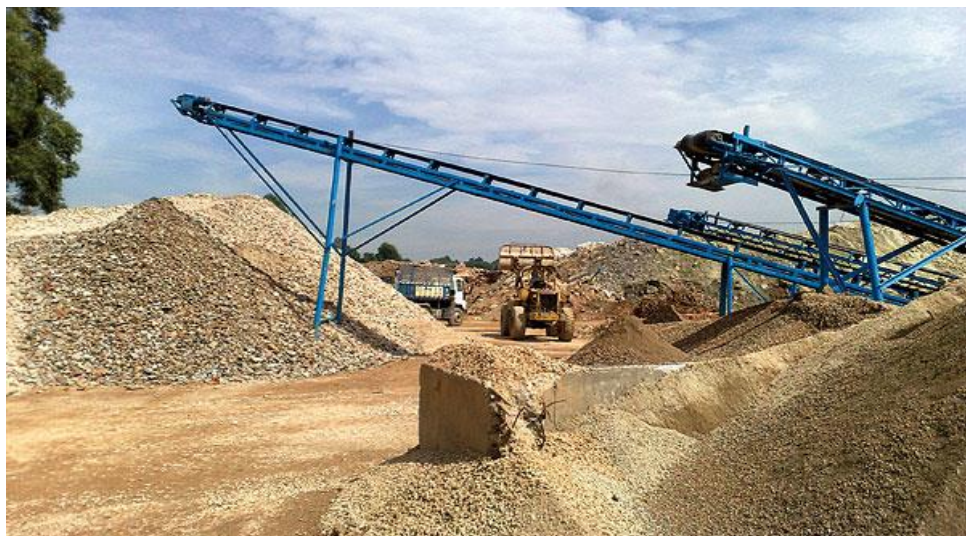
Figura 9- Usina de britagem RCD em São Paulo
