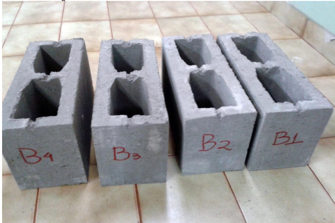
Figura 4- Blocos com fibras recicladas substituindo areia
