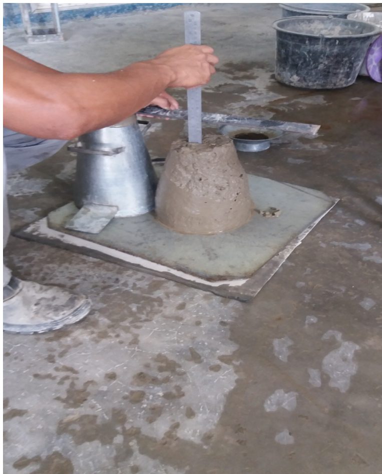
Figura 10: Ensaio slump para medir deformação do concreto.
