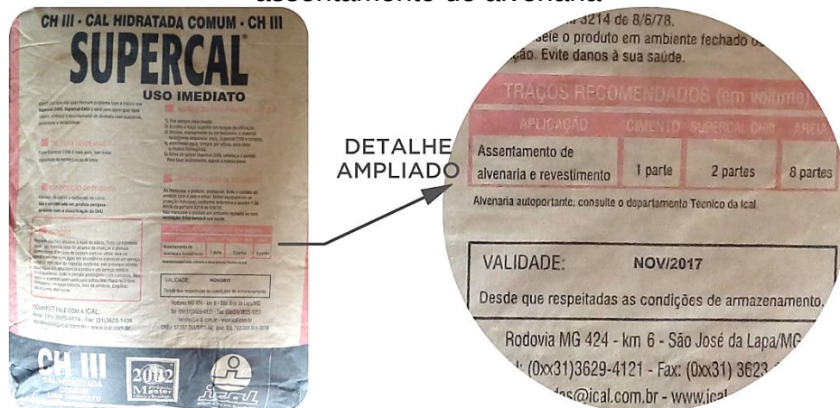
FIGURA 4 – Embalagem de cal hidratada com sugestão de traço de argamassa para assentamento de alvenaria
