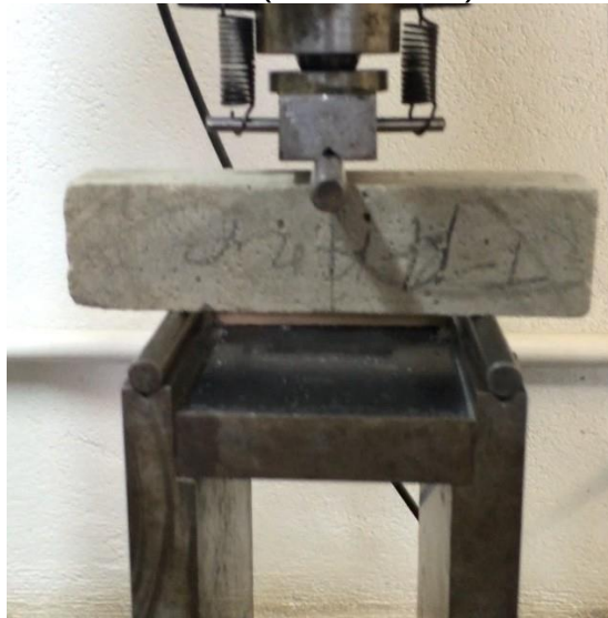
FIGURA 11 – Ensaio de corpos de prova de argamassa regulamentado pela NBR 13279 (ABNT, 2005)
