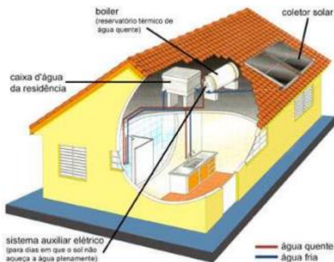
FIGURA 5 – Sistema de energia solar para aquecimento da água.
