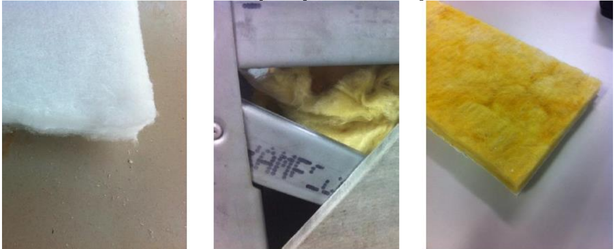
FIGURA 24 – Isolantes térmicos da esquerda para direita: lã de pet, lã de vidro e lã de rocha.
