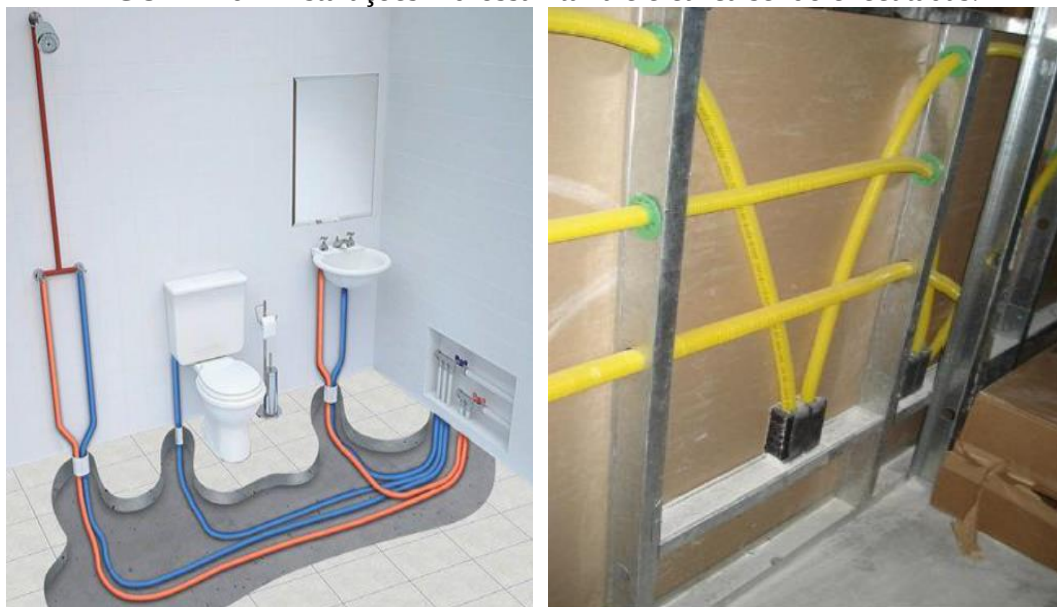
FIGURA 26 – Instalações hidrossanitária e elétrica sendo executadas.
