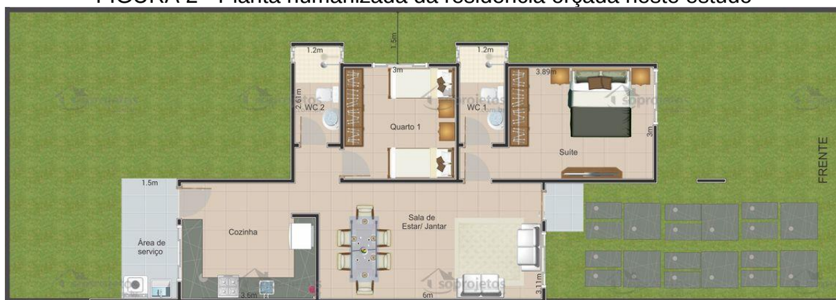
FIGURA 2 - Planta humanizada da residência orçada neste estudo
