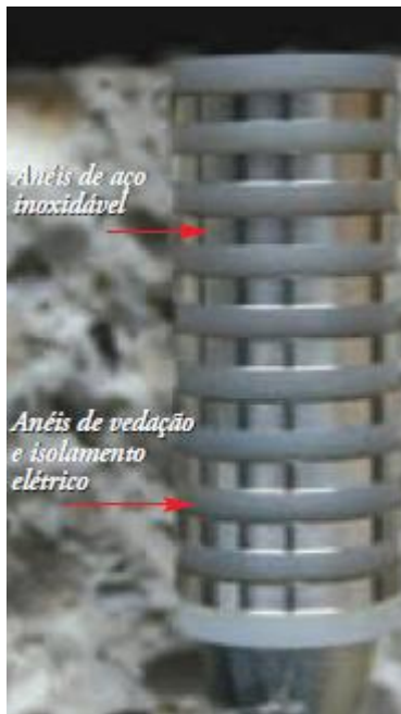
FIGURA 14 - Sensor de umidade, denominado de sensor de múltiplos anéis
