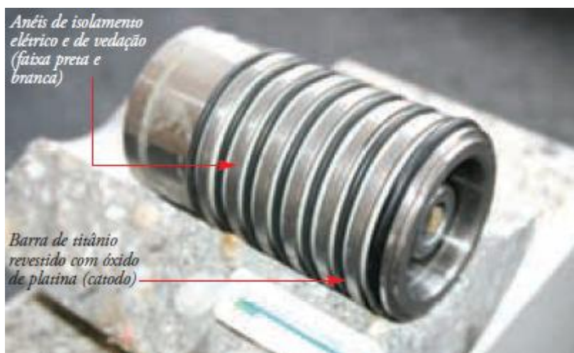
FIGURA 13 - Sensor de anéis expansivos
