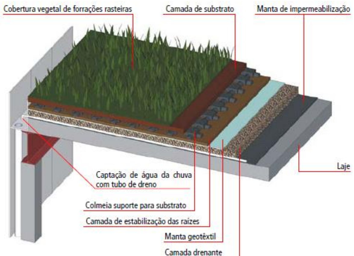
FIGURA 2 – Camadas que compõem o telhado verde.
