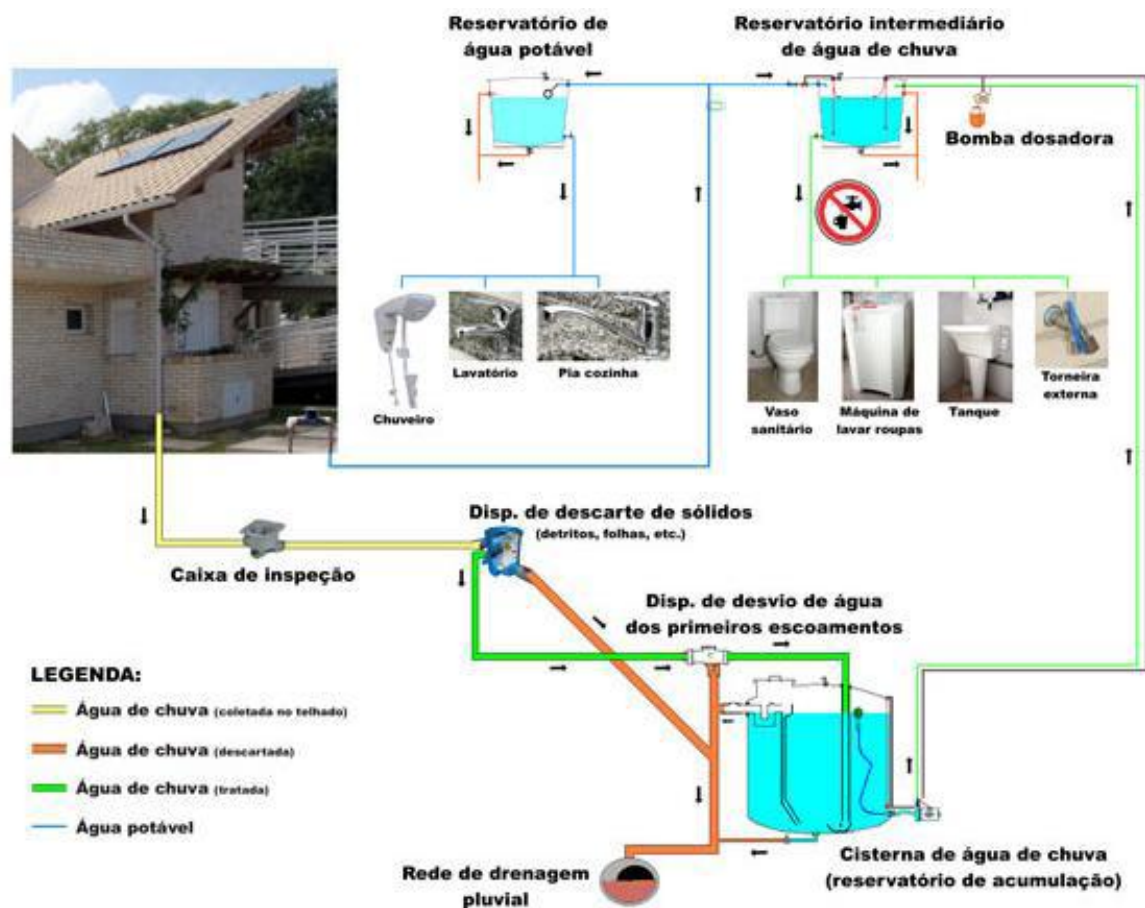
FIGURA 3 - Esquema das instalações destinadas ao aproveitamento
