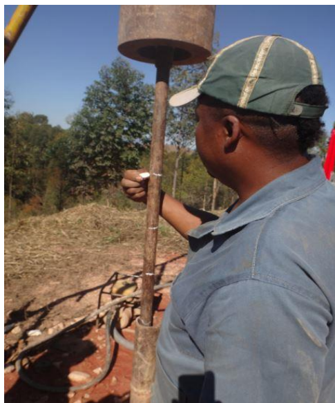
FIGURA 4 - Marcação de 15 cm para dar início a contagem dos golpes.
