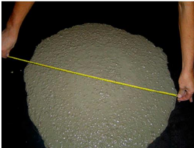
FIGURA 3 - CAA sem segregação pelo ensaio de espalhamento.
