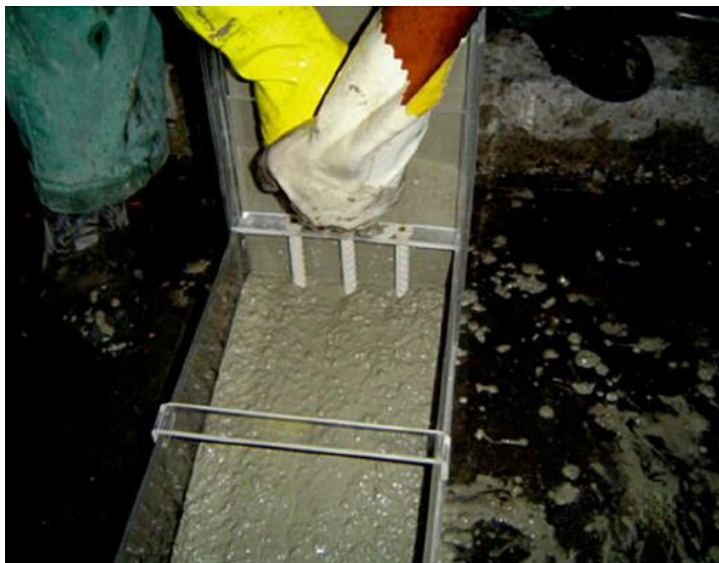
FIGURA 8: Ensaio da Caixa L em andamento.
