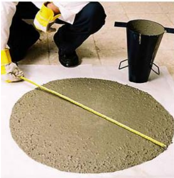
FIGURA 2 - Espalhamento do CAA sendo medido.
