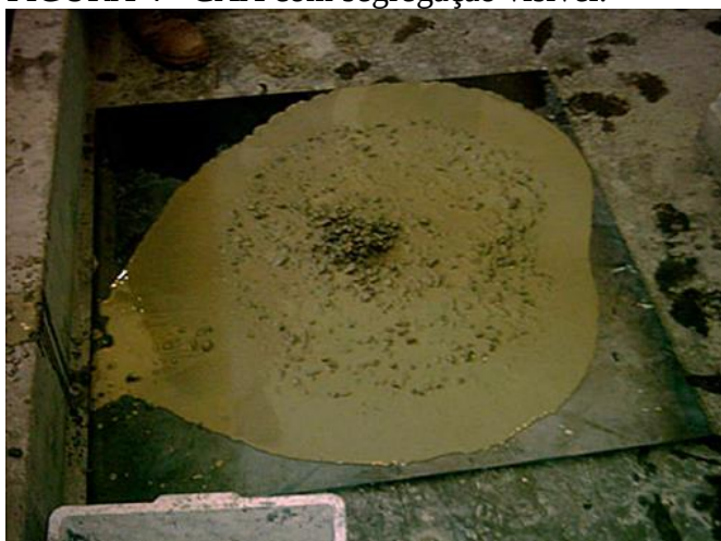
FIGURA 4 - CAA com segregação visível.
