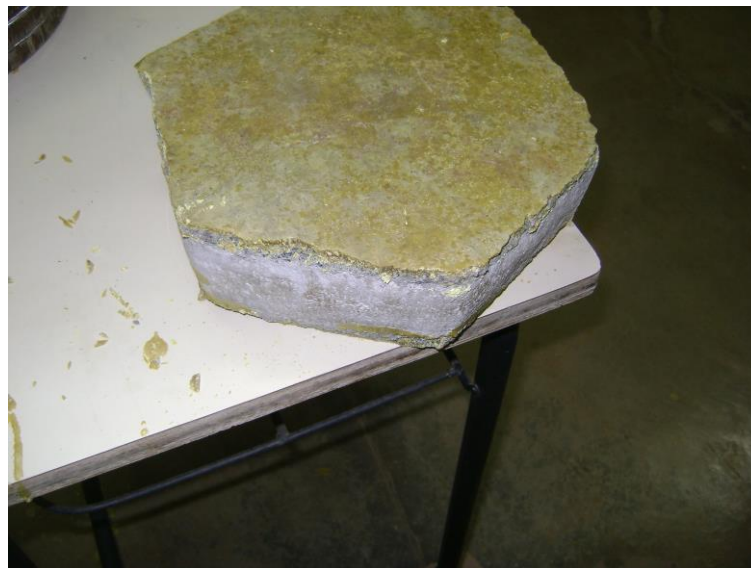
FIGURA 11 – Bloco intertravado intacto após a imposição da carga
