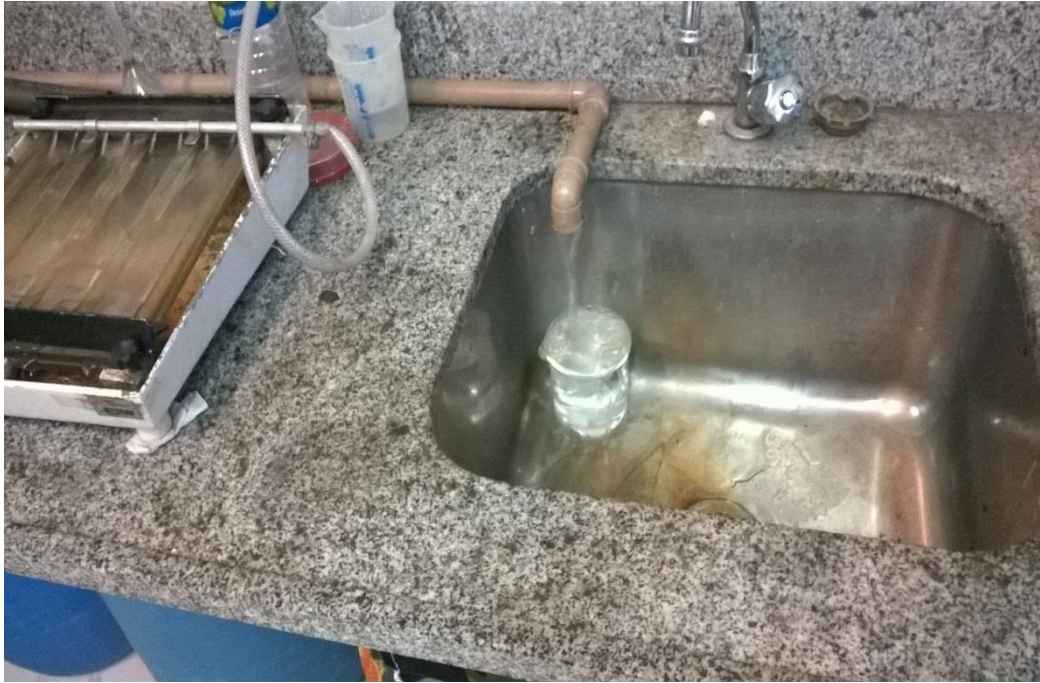
FIGURA 3 – Método para mensurar o volume de água residual oriundo do processo de lixamento
