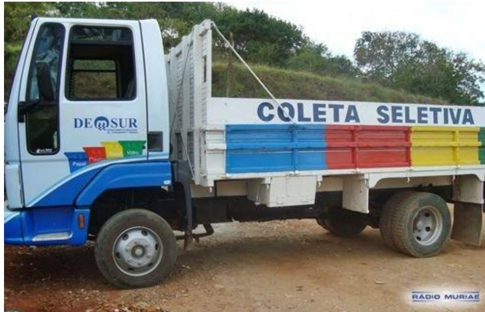
**Figura 4**– Veículo coletor com multi-caçamba (cada cor representa o local adequado para cada matéria recolhido)
