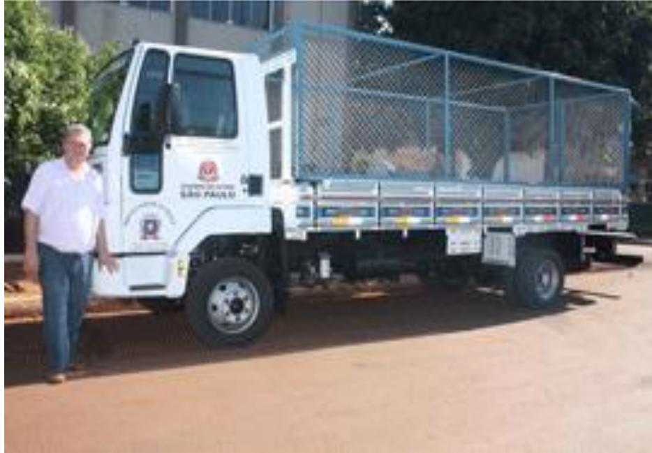
**Figura 5 – Caminhão coletor não compactador**
