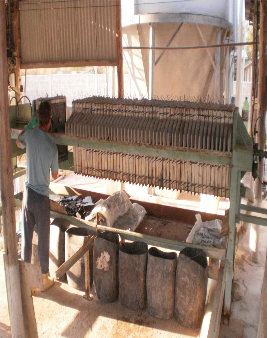
Figura 12 - Operador da ETE retirando as tortas de lodo e acondicionando-as nas bombonas de armazenamento.
