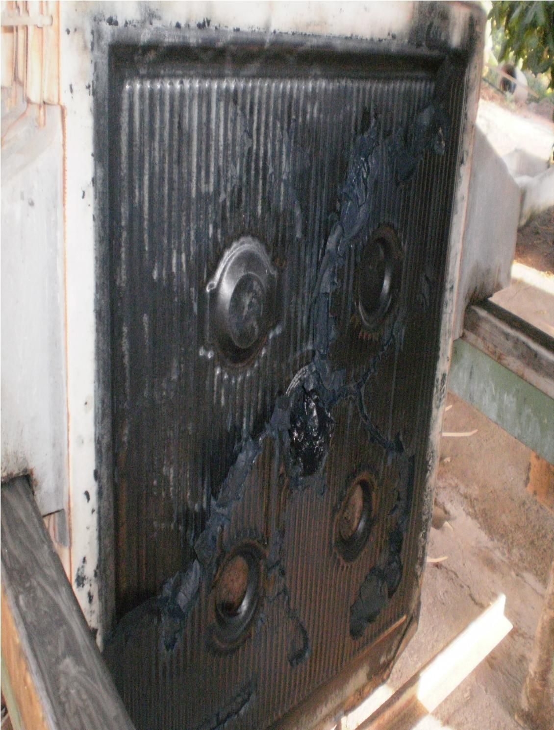
Figura 13 - Placa do Filtro Prensa sendo retirado o lodo filtrado.
