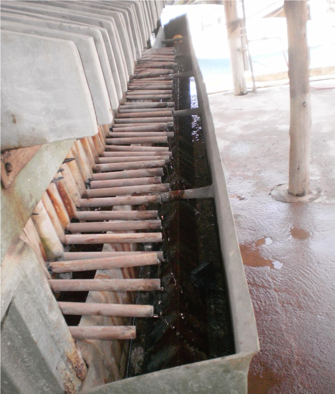
Figura 14 - Tubos de PVC aderidos as placas do Filtro Prensa eliminando a água filtrada do processo.
