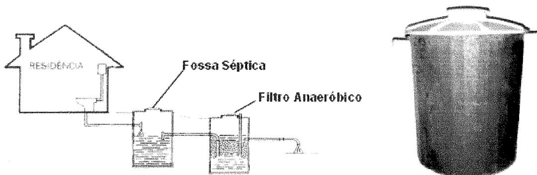
Figura 16: Esquema de tratamento do esgoto sanitário da residência até o corpo receptor através de fossa séptica e filtro anaeróbico
