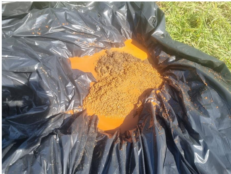
Figura 5 – Amostra de carvão ativado retirado do filtro da comunidade Santa Helena
