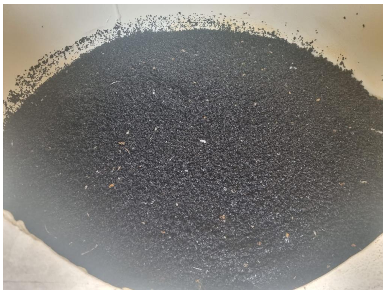
Figura 6 - Zeólita utilizada para filtrar a água fornecida à comunidade Santa Helena
