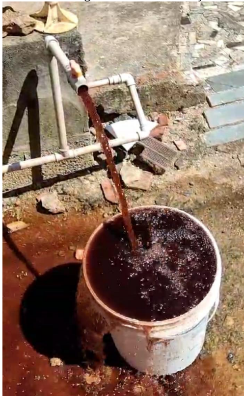
Figura 7 – Desprendimento de ferro e manganês acumulado no interior da rede de abastecimento após restabelecimento do fornecimento de água antes da substituição do carvão ativado por zeólita
