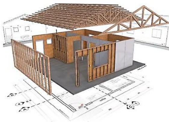
Figura 03 – Esquema estrutural wood frame
