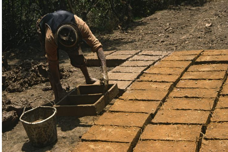
Figura 6- Fabricação de tijolo adobe.
