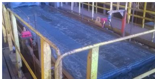
Figura 2 – Filtro de Esteira com minério. Fonte: Dados da pesquisa (2017)
