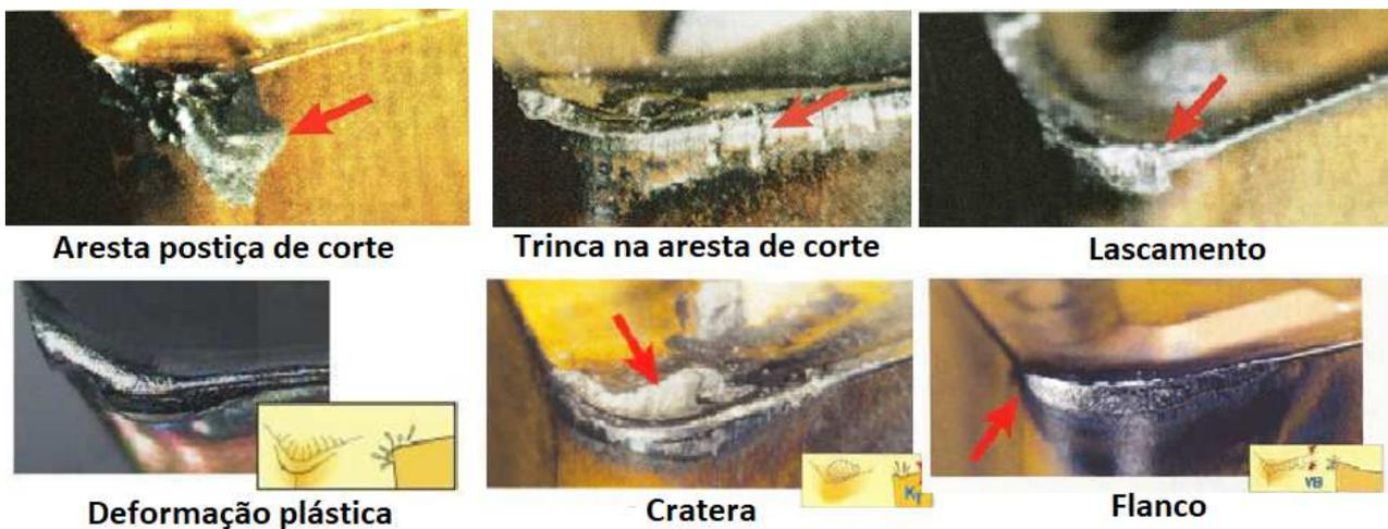
**FIGURA 5.** Fenômenos de desgaste em insertos de ferramenta de corte. Fonte: SANDVIK (2017).
