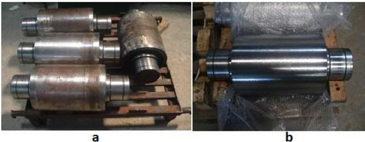
**FIGURA 7.** a) Rolos recebidos do cliente para modificação; b) Rolo após usinagem final. Fonte: Pesquisa direta (2017)
