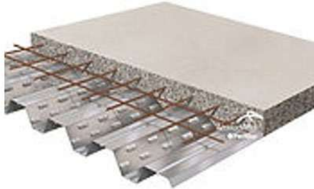
Figura 7 - Estrutura esquemática de lajes úmidas em LSF
